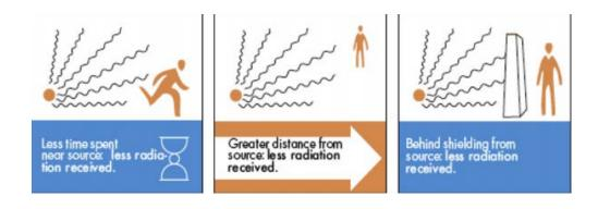
保护原则是尽量减少辐射暴露。时间,辐射源的距离,屏蔽对辐射暴露及剂量吸收的作用。通过减少与放射源的接触时间、增加与放射源间的距离(增加距离能以指数方式减少辐射)和使用屏蔽来使辐射照射最小化。来自核管理委员会。<sup>12</sup>
